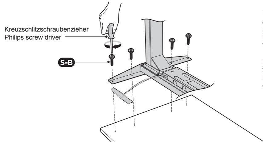
Schrauben sie das Display mit einem Akkuboher an.
