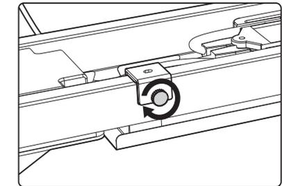
Drehen Sie die Schrauben fest um den Kabelhalter zu fixieren.
