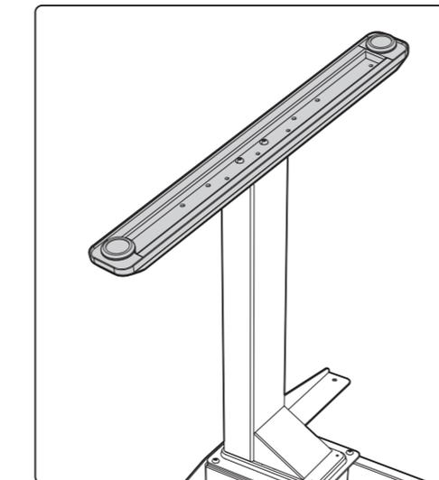
Setzen Sie die FüÙe auf der Unterseite der Beine auf und achten Sie auf die Ausrichtung der Lcher. Schrauben Sie die FüÙe fest und wiederholen dies auf der anderen Seite.
