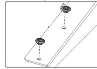
Legen Sie die Tischplatte auf und richten Sie die Platte mit den vorgebohrten Löchern aus. Schrauben Sie jetzt mit den mitgelieferten Schrauben die Tischplatte fest.
