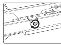
Drehen Sie die Schrauben fest um den Kabelhalter zu fixieren.
