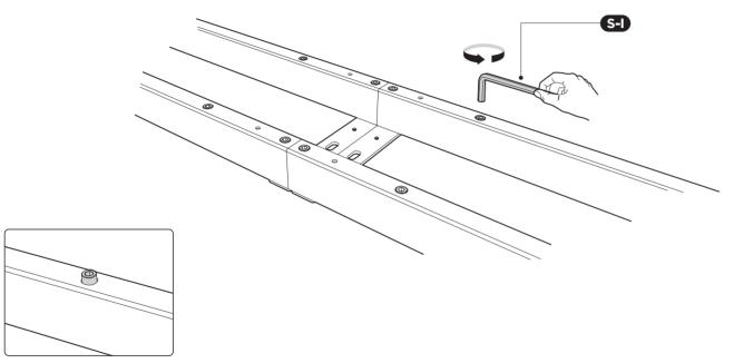
Lösen Sie die Madenschrauben welche die beiden Hälften des Leiterrahmens zusammenhalten, aber entfernen Sie die Schrauben nicht komplett.
